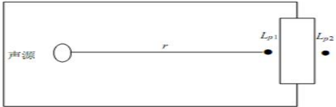
图 4-1 室内声源等效为室外声源图例
